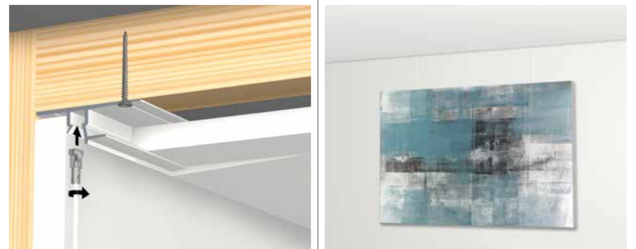
SHADOWLINE DRYWALL (EN ASSOCIATION AVEC DU PLACOPLÂTRE)
